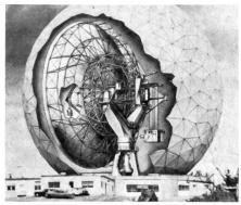
Das größte Radome der Welt in Amerika sieht wie ein Ballon aus. Seine Hülle besteht aus Fiberglas und wird durch Aluminiumstangen gestützt. Wie kompliziert die technischen Einrichtungen im «Heuschober» sind, zeigt dieser Schnitt. Die überaus leistungsfähige Antenne ruht auf einem Y-ähnlichen Turm und ist in der Lage, ihre «Ohren» bis tief ins Weltall zu spitzen. Der zweite Schnitt (links Mitte) ist der von einem Mann bediente Reflektor.
