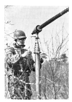
Richtfunkgerät mit «Zigarrenantenne»
