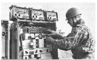
Trägerfrequenzgerät zur Mehrfachausnützung von Leitungen
