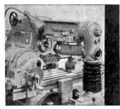
Maschine, ausgerüstet mit Universal-Teilapparat
