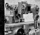
Oberarm «s» mit Universal-Vertikalfräskopf; beide je 360° drehbar
