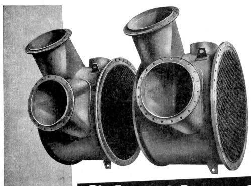
Solche Wärmeaustauscher - ein Beispiel aus unserer leistungsfähigen Werkstätte - sind in einer Fabrik der Chemischen Industrie montiert worden. 847 eingewalzte Stahlrohre ergeben 115 m² Heizfläche, und das Gewicht beträgt 5 t pro Apparat.
