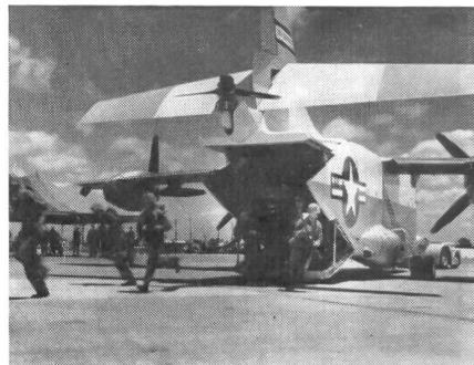
kann. Mit Zusatztanks versehen, beträgt sein Aktionsradius 6000 km. Die Maschine ist 7,8 m hoch, 17,6 m lang und hat eine Flügelspannweite von 21 m. Tic
