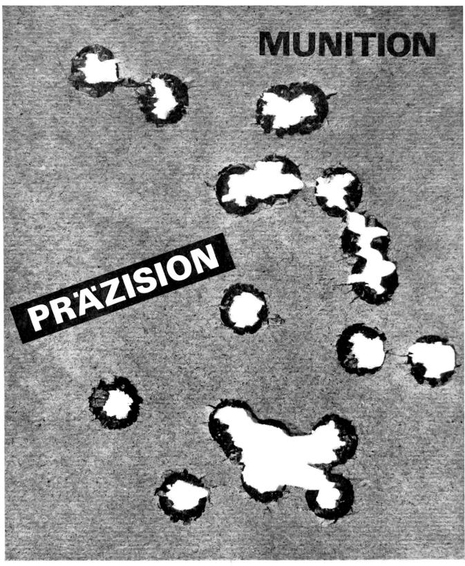
Masstab: 1:1 natürliche Grösse Entfernung 200 Meter 20 Schuss abgegeben von einer 20 mm Hispano Suiza Kanone Ergebnis eines offiziellen Güteprüf - Beschusses
