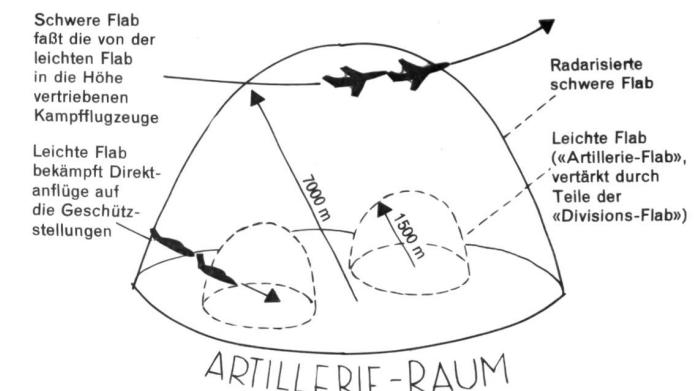
Die Wirkung der Flabwaffen geht nur bis in eine bestimmte Höhe. Die Feindflieger vermögen die Flab zu überspielen, indem sie außerhalb der Reichweite der Geschütze verbleiben. Deshalb benötigt man ein «Waffensystem». Leichte Flabgeschütze mit großer Feuer- und Richtgeschwindigkeit, um Tiefflieger abzuwehren. Mittlere und schwere Flabgeschütze, um die von der leichten Flab in die Höhe vertriebenen Flugzeuge bekämpfen zu können!
