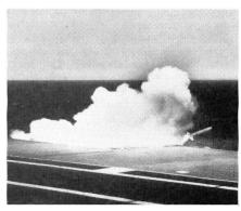
Der Flugzeugträger hat zur Selbstverteidigung zwei Doppelstarter der «Terrier» Flugabwehrraketen. Hier der Start einer Rakete vom achtern Backbord Starter, der sich gerade unter dem Flugdeck befindet.
