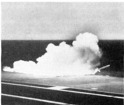
Der Flugzeugträger hat zur Selbstverteidigung zwei Doppelstarter der «Terrier» Flugabwehraketten. Hier der Start einer Rakete vom achtern Backbord Starter, der sich gerade unter dem Flugdeck befindet.
