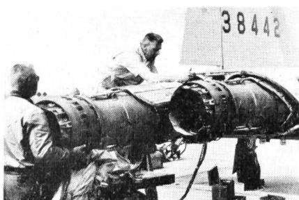
Bei der F-5 können die Motoren in kurzer Zeit von Hand, ohne die Unterstützung besonderer Reparaturfahrzeuge, ausgewechselt werden. Das neue Jagdflugzeug gilt als «Arbeitspferd» unter den modernen Ueberschalljägern.
