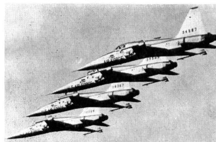
Überschalljäger vom Typ F-5 im Formationsflug. Dank ihrer guten Steigfähigkeit ist der Höhenbereich um 12 000 m bereits nach vier Minuten erreicht. An den Flügel spitzen sind Fernlenkwaffen montiert.
