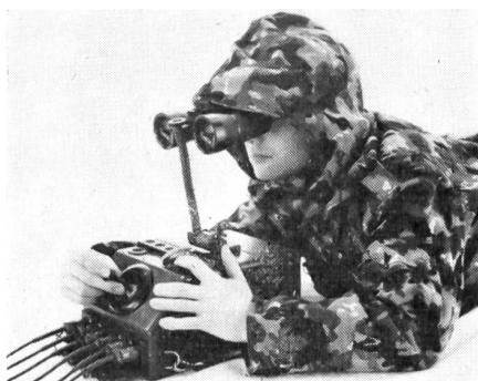
2 MOSQUITO-Schütze am Lenkgerät, an welchem sechs Lenkwaffen angeschlossen sind. Der Schütze wählt die zu startende Lenkwaffe durch Betätigung der Wahlstaste und startet die vorgewählte Lenkwaffe durch Druck auf die Starttaste (Bild). Mittels eines Lenkknöpels wird die Lenkwaffe nach dem Zieldeckungsverfahren ins Ziel gebracht.
