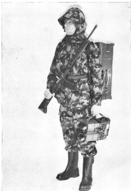
1 MOSQUITO-Schütze mit vollständigem Waffensystem zur Bekämpfung von Panzern auf Distanzen zwischen 400 und 2400 m. Der hier am Rücken getragene Startbehälter enthält eine Lenkwaffe MOSQUITO 64 und die Verbindungskabel (2 x 50 m) zum Lenkgerät. An einem Handriemen rägt der Schütze das Lenkgerät, an welchem gleichzeitig sechs Lenkwaffen angeschlossen werden können.
