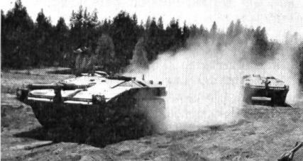
abgeschrägte Frontpanzerung bietet feindlichen Geschossen nur wenige Angriffs punkte, und das geringere Gewicht ermöglicht eine größere Beweglichkeit. Ferner kann der neue Panzer durch eine Art von Bälgen aus Kunststoff schwimmfähig gemacht werden und ist somit in der Lage, Wasserhindernisse selbst zu überwinden.
