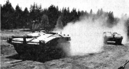
abgeschrägte Frontpanzerung bietet feindlichen Geschossen nur wenige Angriffs punkte, und das geringere Gewicht ermöglicht eine größere Beweglichkeit. Ferner kann der neue Panzer durch eine Art von Bälgen aus Kunststoff schwimmfähig gemacht werden und ist somit in der Lage, Wasserhindernisse selbst zu überwinden.
