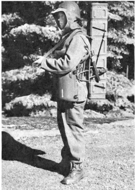
1 Die gesamte Bantam-Apparatur ist leicht von einem Mann zu tragen. Mit wasserabweisendem Transport- und Abschussbehälter, Erhöhungsstütze, Kabel und Kommandogeber wiegt sie 19 kg (die persönliche Ausrüstung mit Maschinengewehr dazu etwa 7 kg).
