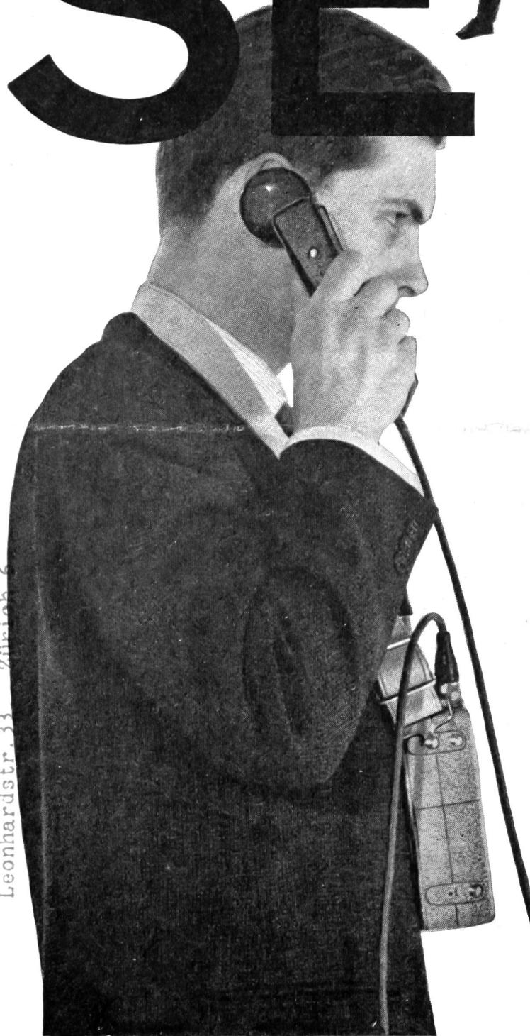
Das Kleinfunkgerät SE 18 der Autophon ist leicht, handlich, leistungsfähig. Es wiegt nur 2,6 kg. Es ist nur 19,8 cm breit, 16,6 cm hoch und 5,5 cm dick: etwa halb so gross wie ein Telefonbuch.
