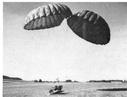
1 Der Abwurf des Kleinfahrzeuges A.S. 24, das nur 220 kg wiegt, erfolgt an zwei normalen Fallschirmen. Es kann von zwei Mann innert einer Minute einsatzbereit gemacht werden.
