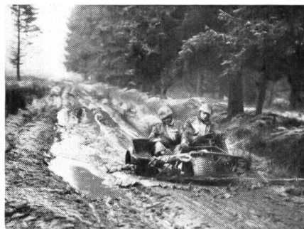
2 Selbst solche Wege meistert der «Westentaschen-Lastwagen» ohne Schwierigkeiten, angetrieben von einem Zweizylinder-Zweitaktmotor. Der Antrieb erfolgt durch beide Hinterräder, das Vorderrad dient zur Lenkung.
