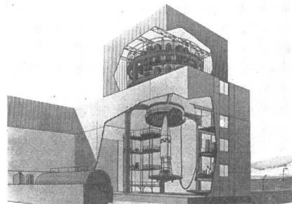
Dieser Aufriß gibt ein ungefähres Bild der gewaltigen Vakuumkammer in Sunnyvale (Kalifornien). Es wird soeben eine Agena-Attrappe in die zylindrische Vakuumkammer eingefahren. Rechts unten der Kontrollraum,
