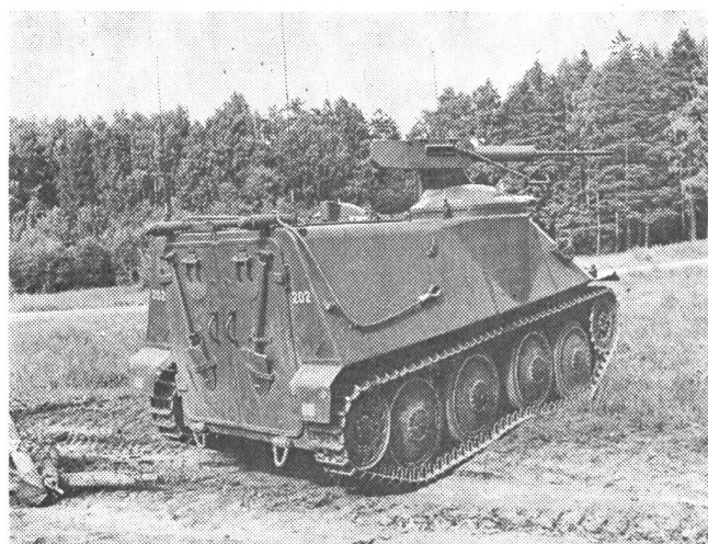
Die schwedische Armee verfügt über einen eigenen leistungsfähigen Schützenpanzerwagen zum Transport der Begleitinfanterie in den Panzertruppen. Er kann 10 Personen, den Chef, den Führer und acht Mann transportieren und ist mit einer 20 mm Automatkanone bewaffnet.
