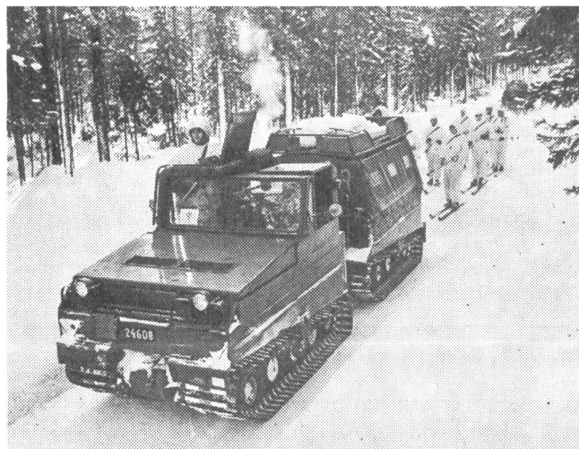
In einer großen Serie wurde dieses zweigliedrige Raupenfahrzeug in Auftrag gegeben. Es handelt sich um eine in Schweden fabrizierte Eigenkonstruktion, die sich vor allem für den Einsatz im Winter eignet, doch auch im Sommer im schwedischen Gelände gute Dienste leistet und in der Armee für alle Arten von Transporten für Material und Truppen Verwendung findet.
