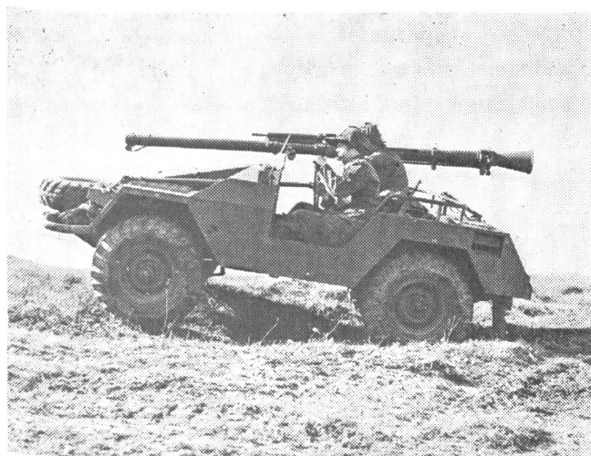
Die neue schwedische Eigenentwicklung, eine 90 mm Panzerabwehrkanone, die Pak Y. Sie kann bis auf 1000 m Distanz eingesetzt werden, und ihre Feuergeschwindigkeit beträgt 4 bis 6 Schuß in der Minute.
