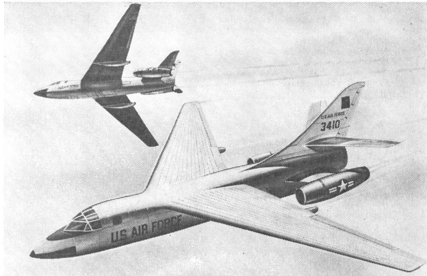
Auf dieser Darstellung der Laminar-Flugzeuge erkennt man auf den Tragflügeln die feinen Einsaugschlitze, die die Luft «verarbeiten» und den Reibungswiderstand herabsetzen.
