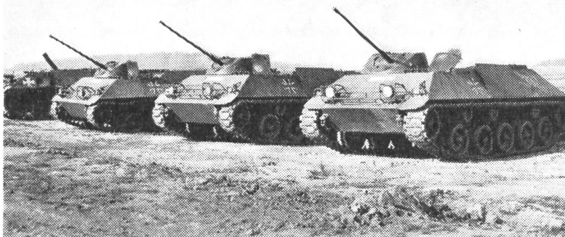
HISPANO SUIZA 20 mm MASCHINEN-KANONEN 820/L 85 - Die erprobte und als NATO-Waffe bewährte Bestückung von Schützenpanzern und motorisierten Einheiten.
