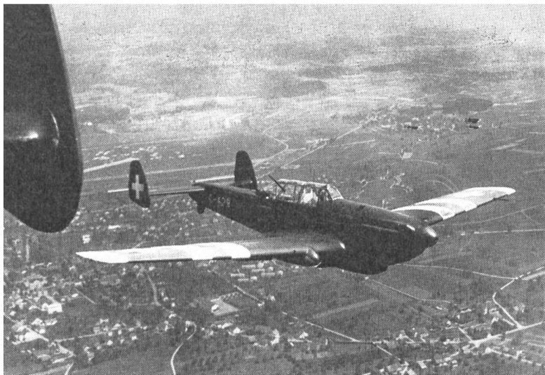
Der in den Eidg. Flugzeugwerken hergestellte C-36 löste den C-35 als Erdkampf- und Aufklärungsflugzeug ab. Max. Geschwindigkeit 470 km/h, Gipfelhöhe 10 000, Reichweite 680 km, Bewaffnung 4 Mg, wovon 2 für den Beobachter, eine Kanone zu 20 mm sowie Spreng-, Splitter- und Brandbomben.
