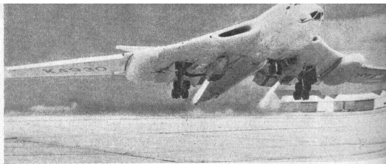
▲ Der vierdüsigte RAF-Bomber «Victor» mit zwei Dehavilland-Spectre-4-Raketentriebwerken für Kurzstarthilfe. Dank dieser Zusatzleistung von 2 x 8000 Pfund für den Start kann dieser Bomber nach 540 m abheben.
