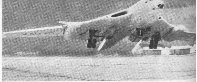
▲ Der vierdüsig RAF-Bomber «Victor» mit zwei Dehavilland-Spectre-4-Raketentriebwerken für Kurzstarthilfe. Dank dieser Zusatzleistung von 2 x 8000 Pfund für den Start kann dieser Bomber nach 540 m abheben.
