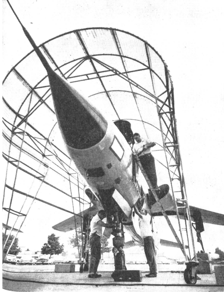
Bild links: Flugbereitschaftskontrolle eines F-105 unter einem fahr- baren Schutzdach.
