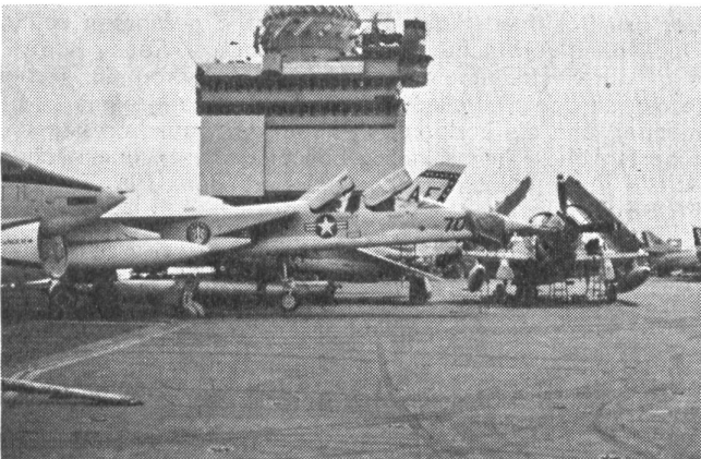
Blick vom Vorderdeck auf den Turm. Zuoberst auf dem Turm erkennt man Admirals-, Kapitäns- und Flugdeckoffiziersbrücke. Im Vordergrund ein Vigilante Bomber und ein Skyraider Flugzeug. Links ist die Nase eines Photo Aufklärers sichtbar.
