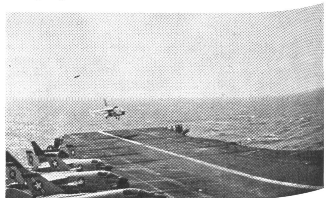
Eine F8E Crusader setzt zur Landung an. Am Anfang der Landebahn ist rechts deutlich der Posten des LSO erkennbar, ebenso sieht man genau die vier aufgespannten Bremskabel, die quer zur Landebahn gespannt sind.
