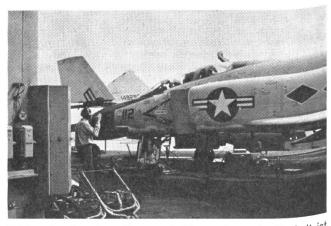
Triebwerkprobe eines Phantom II Allwetterjäger. Im Cockpit ist der Helm des Piloten sichtbar, der sich mit Fingerzeichensprache mit dem Ueberwachungsoffizier (links, mit Ohrenschutz) verständigt.
