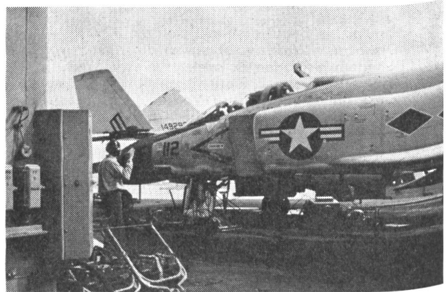
Triebwerkprobe eines Phantom II Allwetterjägers. Im Cockpit ist der Helm des Piloten sichtbar, der sich mit Fingerzeichensprache mit dem Ueberwachungsoffizier (links, mit Ohrenschutz) verständigt.
