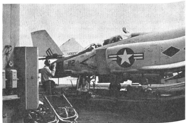
Triebwerkprobe eines Phantom II Allwetterjägers. Im Cockpit ist der Helm des Piloten sichtbar, der sich mit Fingerzeichensprache mit dem Ueberwachungsoffizier (links, mit Ohrenschutz) verständigt.
