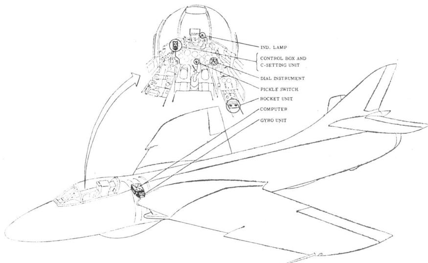
Einbau des Zielsystems SAAB BT-9 in einem HUNTER-Jagd- und Kampfflugzeug
