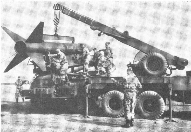
Die Atombewaffnung der Verbündeten geht voran. Soldaten der deutschen Bundeswehr bei der Ausbildung am «Honest John», einer ballistischen Kurzstreckenrakete (Länge 9 m, Reichweite 20 bis 35 km).
