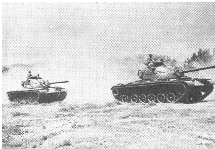
Panzer im Angriff (Pz. M 48 A 2) Man beachte die Fl. Mg-Kuppel zum Schutze des Schützen
