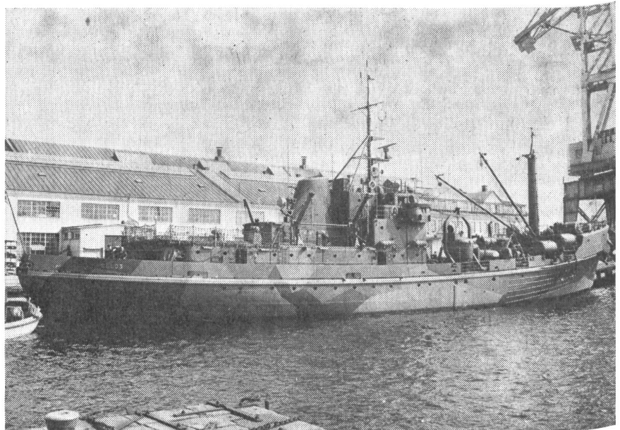
Das ist das erste U-Boot-Rettungsschiff der Welt. Es ist mit modernsten technischen Schikanen ausgerüstet, um eine verunglückte U-Boot-Besatzung aus großer Tiefe heraufzuholen
