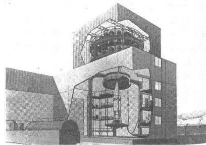
Dieser Aufriß gibt ein ungefähres Bild der gewaltigen Vakuumkammer in Sunnyvale (Kalifornien). Es wird soeben eine Agena-Attrappe in die zylinderförmige Vakuumkammer eingefahren. Rechts unten der Kontrollraum,
