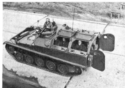
Ein neuartiger, gepanzerter Truppentransporter wird zur Zeit in der französischen Armee erprobt. Das Fahrzeug verfügt über ein Maschinengewehr Kal. 7,5 oder 12,7 für Rundumverteidigung und kann, den Führer eingeschlossen, 12 Mann befördern.
