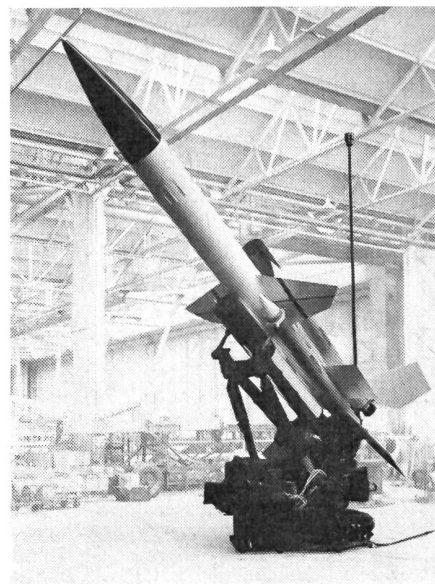
Bloodhound Mk. 2 Flab-Lenkwaaffe; eine Weiterentwicklung der Bloodhound Mk. 1, die bei der Royal Air Force und in Schweden im Dienst steht.
