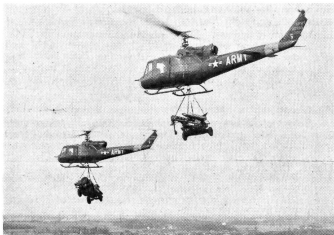
Die Lenkwaffe «Little John» wird mittels des Hubschraubers «Iroquois» in das Einsatzgelände transportiert. Dieser Hubschrauber vermag etwa 2 Tonnen aufzunehmen.
