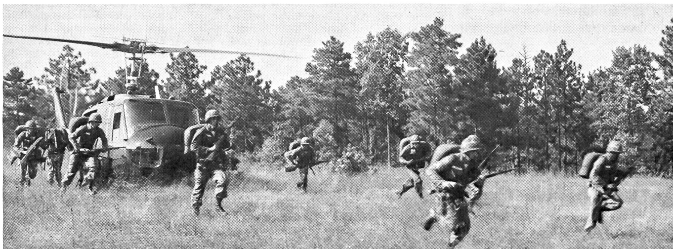
Der schwere Hubschrauber hat eine Kampfgruppe Soldaten in die Gefechtszone transportiert. Der «Iroquois» transportiert normalerweise 8 voll ausgerüstete Soldaten plus Pilot; eine stärkere Variante dieses Bell-Hubschraubers nimmt 13 Soldaten auf.
