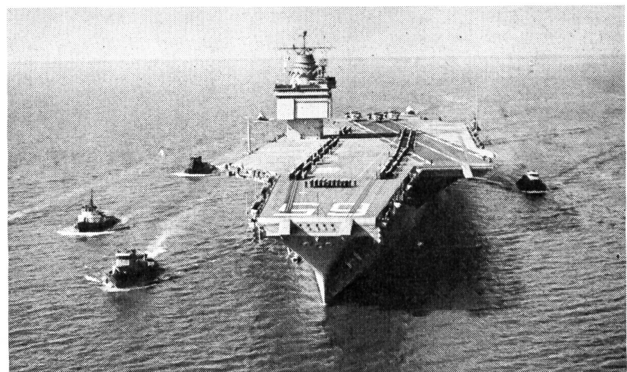
Für die Bedienung der vier Katapulte stehen vier Aufzüge zur Verfügung, die innerhalb von Sekunden die Flugzeuge aus dem Hangardeck auf das Flugdeck bringen (vorne). Rechts hinten: Der Kommandoturm mit seinem Gehirn, das das größte und modernste je auf einem Schiff erstellte Zentrum elektrischer und elektronischer Einrichtungen besitzt.
