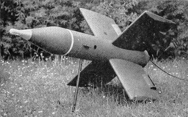
Mit der MOSQUITO werden gepanzerte Ziele in Distanzen von 400 bis 2000 m bekämpft. Der Hohlladungskopf durchschlägt Panzerplatten von über 500 mm.
