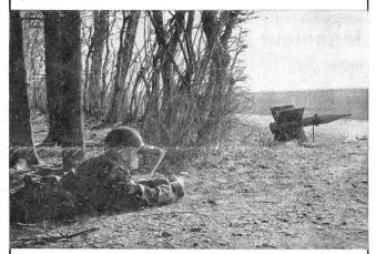
Die MOSQUITO wird ohne Abschussgestell direkt vom Boden gestartet , und der Schütze lenkt sie mittels eines Lenkknüppels über elektrische Signaldrähte ins Ziel. Für Übungsschlessen wird der Kriegskopf durch einen Übungs-Fallschirmkopf ersetzt, womit die Rakete nach erfolgtem Fluge zurückgewonnen werden kann.
