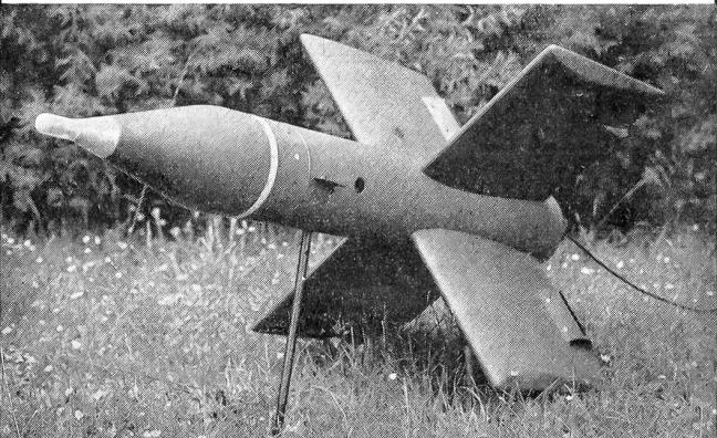
Mit der MOSQUITO werden gepanzerte Ziele in Distanzen von 400 bis 2000 m bekämpft. Der Hohlladungskopf durchschlägt Panzerplatten von über 500 mm.
