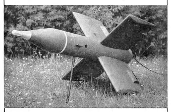
Mit der MOSQUITO werden gepanzerte Zlele in Distanzen von 400 bls 2000 m bekämpft. Der Hohlladungskopf durchschlägt Panzerplatten von über 500 mm.
