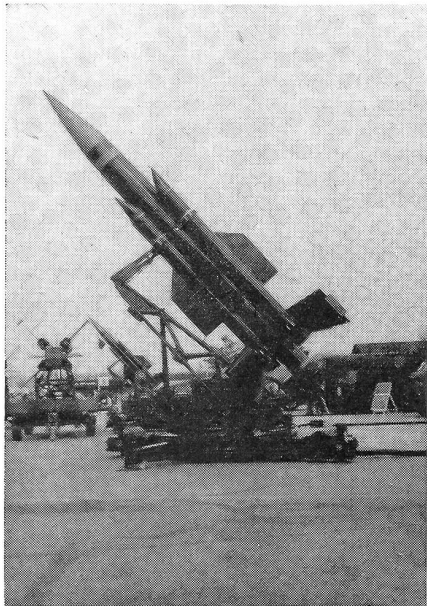
Thunderbird Mk. 2. Diese radargelenkte Rakete ist die Standard-Fliegerabwehrwaffe der englischen Armee, mit welcher ebenfalls ihre Rhine-Armee ausgerüstet wurde. Schußdistanz: bis 20 000 m.
