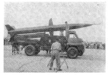
Blue Water, Englands erste Boden-zu-Boden-Rakete. Der das Geschoß transportierende Camion ist zugleich seine Abschußrampe. Maximale Schußdistanz etwa 70 km. Diese Rakete kann mit einem Atomsprengkopf versehen werden.
