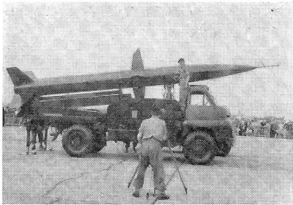
Blue Water, Englands erste Boden-zu-Boden-Rakete. Der das Geschoss transportierende Camion ist zugleich seine Abschussrampe. Maximale Schußdistanz etwa 70 km. Diese Rakete kann mit einem Atomsprengkopf versehen werden.
