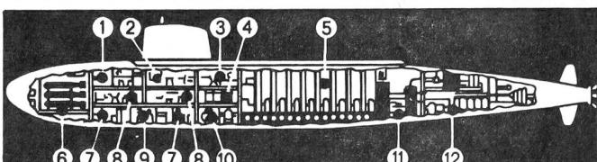
① Offizierskabinen, ② Schiffszentrale, ③ Navigationsraum, ④ Kontrollstation, ⑤ 16 Startröhren für Polaris-Raketen, ⑥ Torpedoraum, ⑦ Stauräume, ⑧ Messen, ⑨ Mannschaftslogis, ⑩ Kreiselkompass, ⑪ Atomreaktor ⑫ Maschinenanlage
