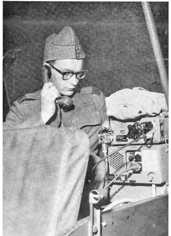
Die Schweizer Armee ist mit einem frequenzmodulierenden Kleinfunkgerät SE 206-209 ausgerüstet, das als Verbindungsmittel für Distanzen von 5—20 km eingesetzt wird. (Fotopress)
