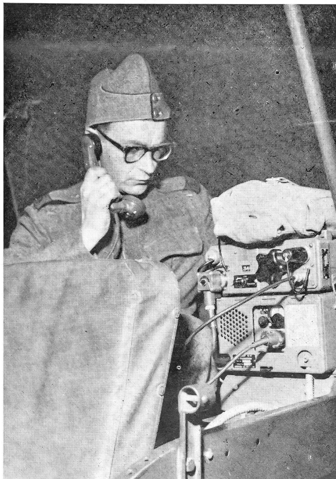
Die Schweizer Armee ist mit einem frequenzmodulierenden Kleinfunkgerät SE 206-209 ausgerüstet, das als Verbindungsmittel für Distanzen von 5—20 km eingesetzt wird. (Fotopress)
