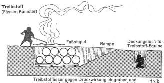
Treibstoffässer gegen Druckwirkung eingraben und gegen Hitzestrahlung zusätzlich abdecken (zugleich Tarnung gegen Fliegersicht)
