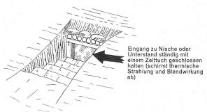
— Grabenverkleidungen aus leicht brennbarem Material (Sandsäcke, Faschinen) geraten bei nahen Atomdetonationen leicht in Brand. Bei durchgehender Verkleidung langer Grabenwände werden alle 50 m «Brandlücken» von 4 m Breite gelassen, damit das Feuer nicht weitergreifen kann.
