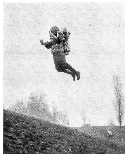
Der amerikanische Ingenieur Harold Graham, von der Firma Bell Aerosystems Company, hat mit dem Versuchsmodell eines Raketengürtels viele erfolgreiche Versuche unternommen, die ihn zum ersten «fliegenden Menschen» werden ließen. Der Raketengürtel besteht aus einem Behälter mit Wasserstoffsuperoxyd, das beim Kontakt mit einem gasförmigen Katalysator aus zwei Öffnungen entweicht und dadurch den Träger des Gürtels mühelos in die Höhe hebt.
