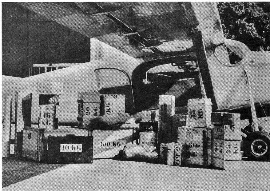
Fassungsvermögen an Kleingütern im PORTER-Flugzeug: Das Flugzeug besitzt einen großen quaderförmigen Laderaum mit ebenem Kabinenboden. Die Doppeltüren gewährleisten bequemen ungehinderten Ein- und Auslad.
