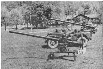
Ausschnitt aus der Waffenschau mit der 10,6 cm rückstoßfreien Panzerabwehrkanone, vorne in Bodenstellung, hinten auf einem Jeep montiert.
