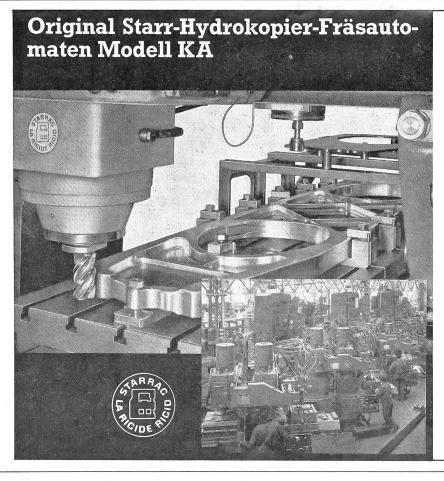
Original STARR-Hydrokopier-FRÄSAUTOMATEN in ein- oder mehrspindliger Ausführung
