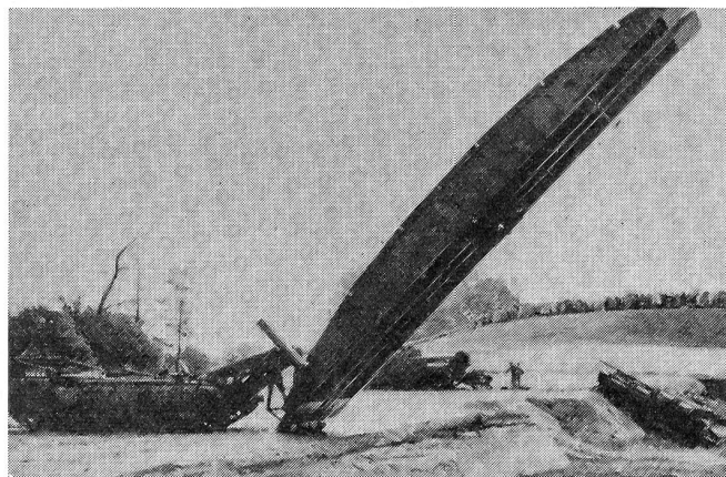
Brückenlegepanzer ermöglichen eine flüssige Bewegung mechanisierter Verbände über Wasserhindernisse hinweg.
