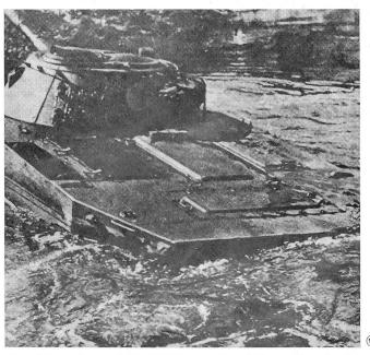
**76-mm-Kampfpanzer 18 t, PT-76,** schwimmfähiges Kampfmittel der russischen Aufklärungsabteilungen und mech. Inf.Verbände, Dieselmotor, 4 Mann. Vorwärtsbewegung mit Hilfe zweier Wasserdüsen, deren Öffnungen im Fahrzeug-Heck liegen. Einheitschassis der 10-t-Klasse.
