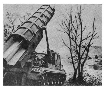
Selbstfahr-Lenkwaffen-Werfer, für eine taktische Mittelstrekken-Lenkwaffe, Flugkörper abschußbereit, Einheitschassis der 50-t-Gewichtsklasse, Dieselmotor, Kampfmittel der russischen Artillerie-Div.
