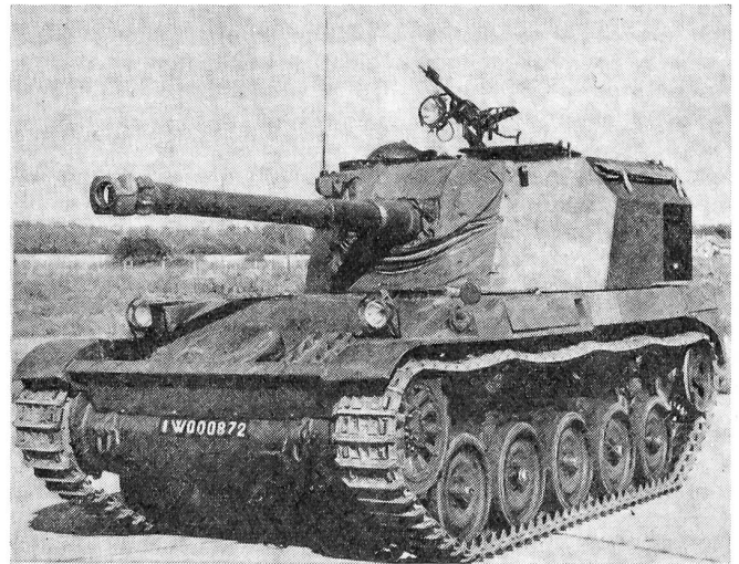
105-mm-Selbstfahraubitze 18 t, AMX mit Drehturm, Flab.Mg., Begleitartillerie der französischen Mech. Div. 1959, Reichweite 14 km, 7 Mann.
