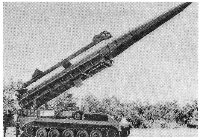
Selbstfahrworfer der taktischen Mittelstrecken-Lenkwanne «Pershing». Fahrzeuggewicht 5 t, ungepanzert, Artillerie der US-Armee, mit einer Reichweite bis 800 km.
