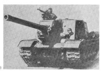
122-mm-Sturmgeschütz 50 t, ISU-122 der russischen Mech. Div. Kein Drehturm, starke Panzerung, mit Flab.Mg., Dieselmotor.
