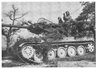
**76/120-mm-Kampfpanzer 13 t, AMX-13** Kampfmittel der französischen Div. 59, ausgerüstet zusätzlich mit 4 Panzerabwehr-Lenkwaffen SS-11, Reichweite derselben bis 2 km, auf Einheitschassis AMX.
