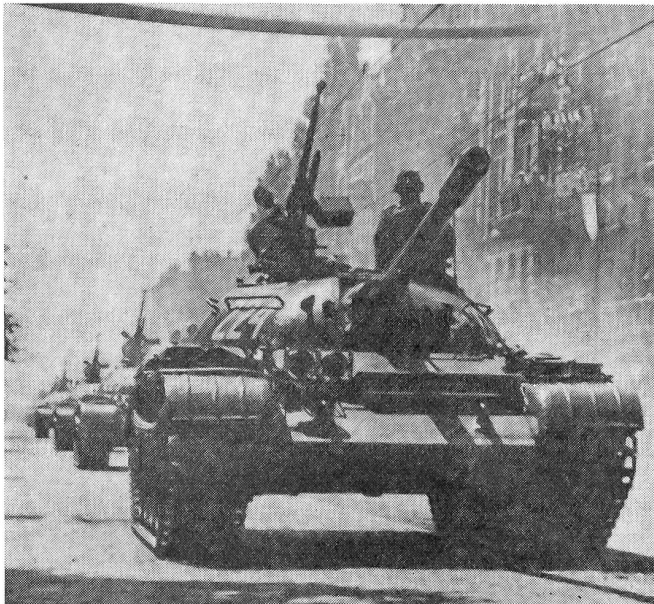
100-mm-Kampfpanzer 35 t, T-54 Kampfmittel der russischen mech. Div. mit Flab.Mg., 4 Mann, Dieselmotor, Einheitschassis der 30-t-Klasse.
