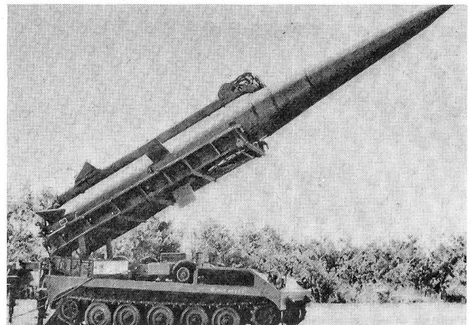
Selbstfahrwerfer der taktischen Mittelstrecken-Lenkwanne «Pershing». Fahrzeuggewicht 5 t, ungepanzert, Artillerie der US-Army, mit einer Reichweite bis 800 km.
