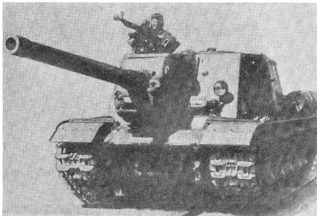
122-mm-Sturmgeschütz 50 t, ISU-122 der russischen Mech. Div. Kein Drehturm, starke Panzerung, mit Flab.Mg., Dieselmotor.
