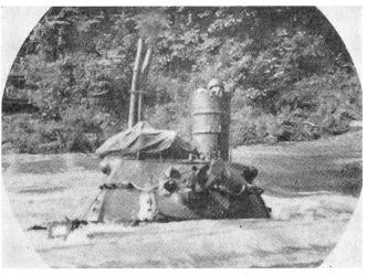
105-mm-Kampfpanzer M-60 beim Durchfahren eines Flusses. Durch Verwendung einer speziellen Ausrüstung konnte die Watfähigkeit wesentlich gesteigert werden (USA).
