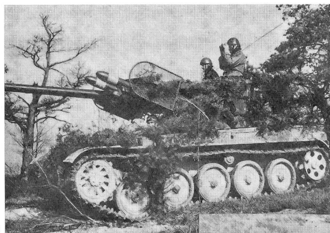
76/120-mm-Kampfpanzer 13 t, AMX-13 Kampfmittel der französischen Div. 59, ausgerüstet zusätzlich mit 4 Panzerabwehr-Lenkaffen SS-11, Reichweite derselben bis 2 km, auf Einheitschassis AMX.
