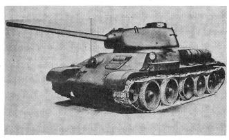
**85-mm-Kampfpanzer 35 t, T-34/85** in den Armeen der Satellitenstaaten in großer Zahl vorhanden, Dieselmotor, 5 Mann, Einheitschassis der 30-t-Klasse.
