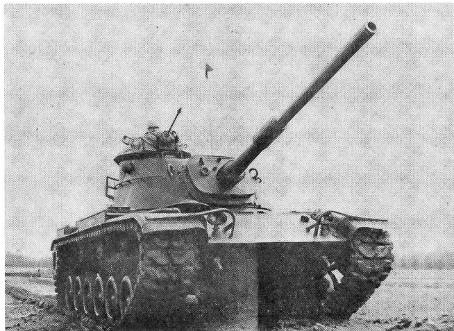
105-mm-Kampfpanzer 55 t, M-60 , Kampfmittel der in Westdeutschland stationierten US-Panzerdivisionen, mit Flab.Mg., 4 Mann, Dieselmotor.
