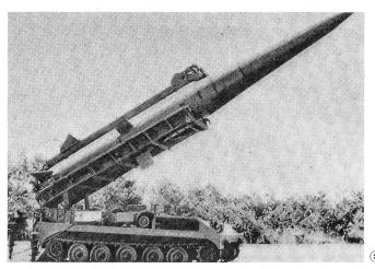
**Selbstfahrwerfer** der taktischen Mittelstrecken-Lenkwaffe «Pershing». Fahrzeuggewicht 5 t, ungepanzert, Artillerie der US-Army, mit einer Reichweite bis 800 km.
