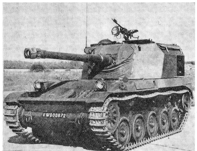
105-mm-Selbstfahrlaubitze 18 t, AMX mit Drehturm, Flab.Mg., Begleitartillerie der französischen Mech. Div. 1959, Reichweite 14 km, 7 Mann.
