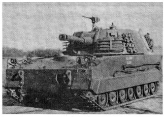
105-mm-Panzerhaubitze 20 t, T-195, mit Flab.Mg., Begleitartillerie der US Mech. Div., Drehturm, 5–6 Mann.
