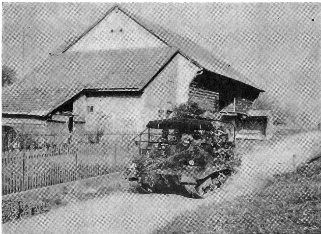
Der «Universal-Carrier», das leichtgepanzerte Raupenfahrzeug der Panzergrenadiere, das durch den Schützenpanzerwagen ersetzt werden soll.
