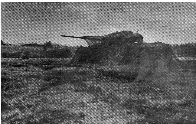
Mit Tarnnetzen kann sich der mittlere Panzer auf offenem Feld gegen Fliegerversicht tarnen.
