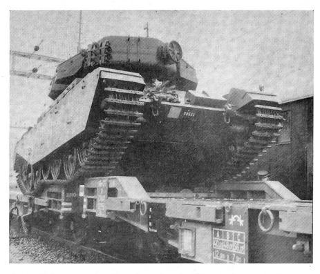
Für den Bahntransport des «Centurion» haben die SBB einen besonderen Transportwagen entwickelt. Mit dem Bahntransport können größere Panzerverschiebungen auf der Straße und damit Störungen des Verkehrs und Beschädigungen des Verkehrsnetzes vermieden werden.
