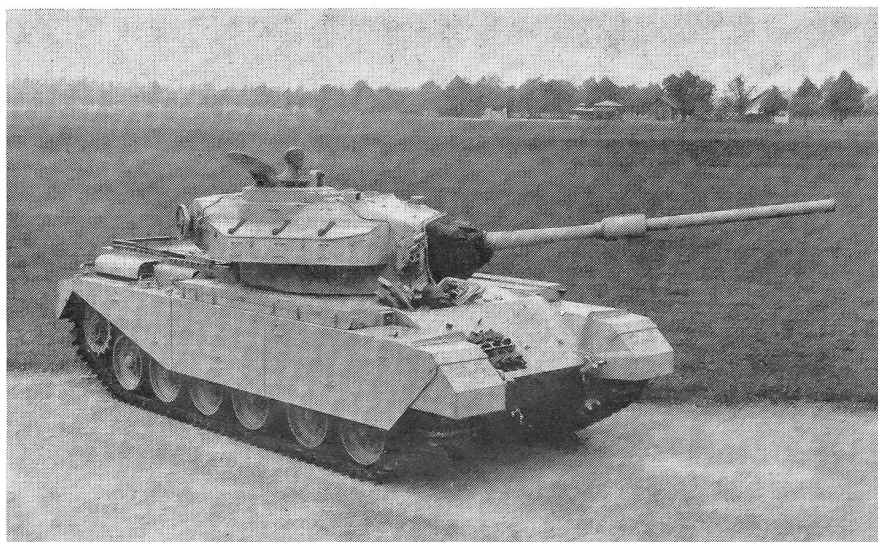
Der mittlere Panzer «Centurion Mk. III» mit dem 8,4-cm-Geschütz
